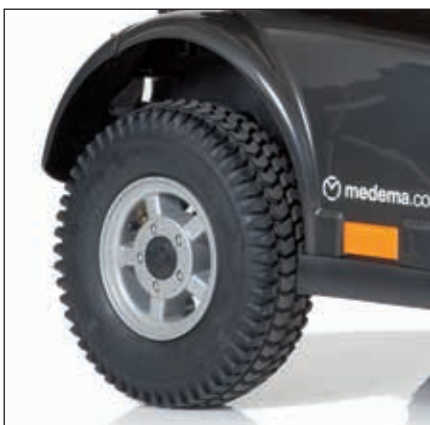
Rad, 13x3.00-8", komplett. Schwarz, 6 PR für M-Modell. T-127-3-065 Rad, 13x3.00-8", komplett. Schwarz, 6 PR pannengesichert für M-Modell. T-127-3-068
