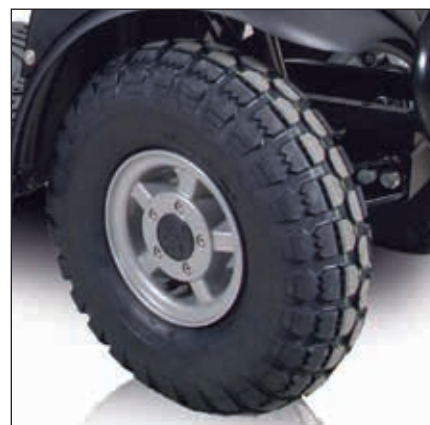
Rad, komplett 6" Ø 370 mm, 530/4,50-6", schwarz, 4 PR für M-Modell. T-127-3-765 Dieses Rad kann auf allen 4-rädrigen Mini Crossern sowohl vorne wie hinten verwendet werden. Beim 3-Rad-Modell kann es nur hinten verwendet werden. Bitte beachten, dass der Wendekreis größer wird, wenn dieser Radtyp an den Vorderrädern verwendet wird. M-127-06-150
