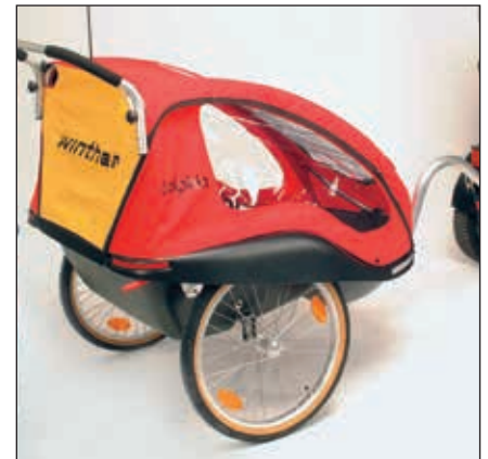
Dolphin Kinderanhänger, mit Kugelkupplung. Max. Belastung 45 kg. T-127-06-106
