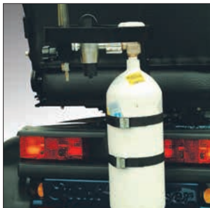
Sauerstoffflaschenhalter. Auf der C-Schiene montiert. Auch nach Muster Möglich. 1506-1253
