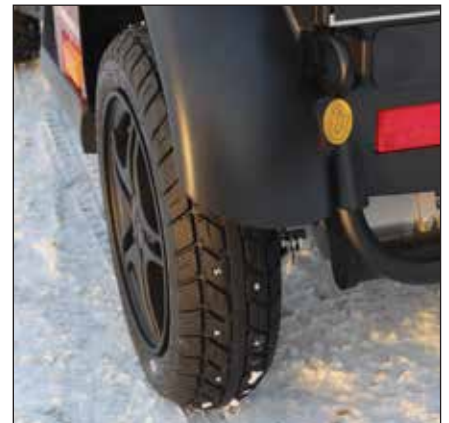
Rad, model-x, 2,50-3,70-8\"/> schwarz. 6 PR mit Spikes – non marking. 1503-1008
